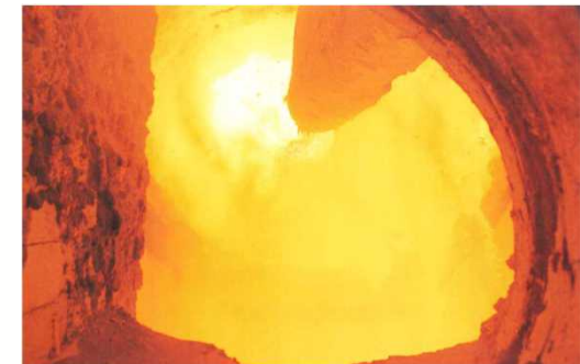
クリンカ焼成中の回転窯の内部
