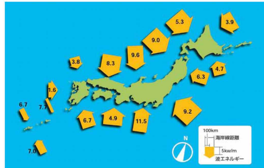
図 日本沿岸の波力エネルギー(kW/m)
