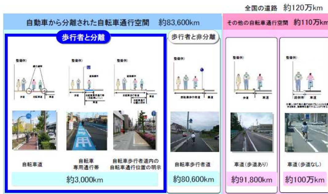
自転車通行空間の整備状況(延長は道路延長。平成22年3月時点)
