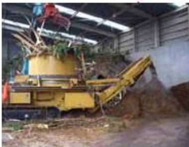
●1次破碎機 間伐材や建設廃材を100mm以下まで効率よく破碎します。
