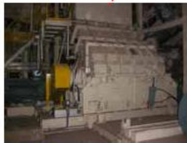
●2次破碎機 1次破碎機で破碎された木屑をさらに40mm以下まで効率よく破碎します。
