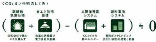
「CO<sub>2</sub>オフ住宅」は、高い断熱性能や高効率な設備機器等の導入により居住時のCO<sub>2</sub>の排出を極力抑えたうえで、エネルギー消費に伴うCO<sub>2</sub>排出量を、太陽光発電システムと燃料電池の発電による削減効果で相殺することにより、計算上のCO<sub>2</sub>排出量が差し引きほぼゼロとなる「CO<sub>2</sub>オフの暮らし」を提案します。
