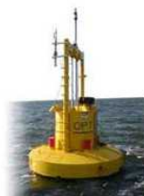
図 PB150 PowerBuoy 波力発電装置
