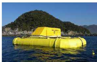
図 ジャイロ式波力発電装置 (4号機: 45kW機)
