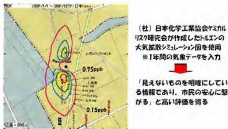
図 2-3 トルエンの大気拡散シミュレーション
