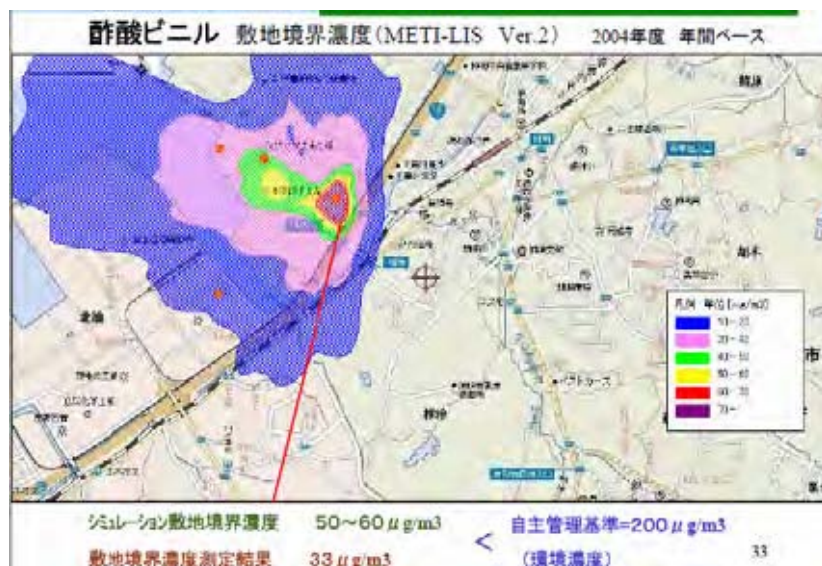
図 2-6 酢酸ビニルの大気拡散シミュレーション
