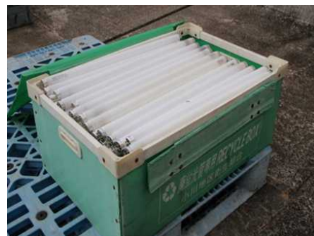
写真 2.4.2 蛍光管の保管容器の例 （出荷時は蓋をする）
