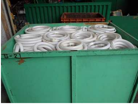
写真 2.4.3 蛍光管の保管容器の例 (出荷時は蓋をする)
