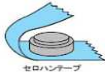
図 2.2.1 ボタン電池の絶縁方法例 7
