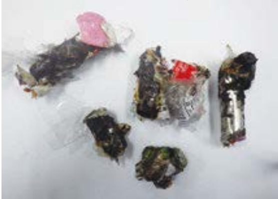
発火原因となったリチウムイオン電池
