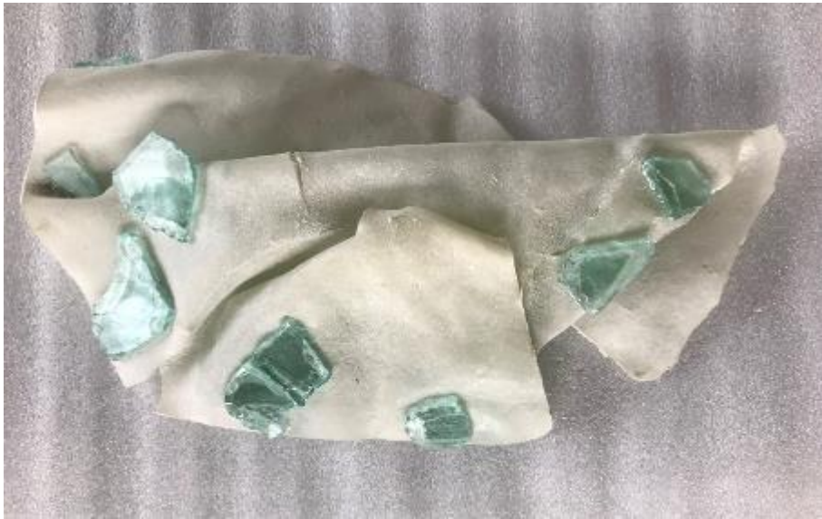
フロントガラスの乾式工程途中
