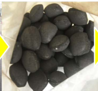
CF含有ASRを炭化炉に 投入し、生成したブリケット
