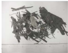
破碎後の水素タンク
