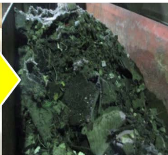
ブリケットを電炉に投入
