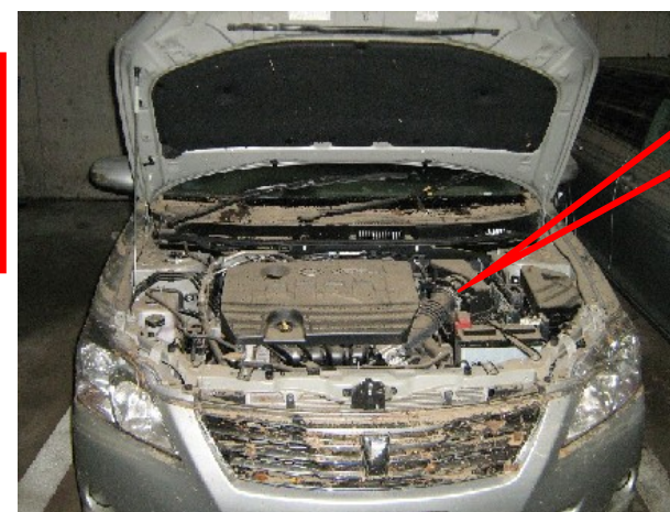
エンジンルーム内も水没の痕跡あり。
