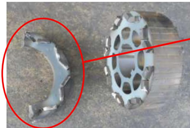
電磁鋼板と磁石を分離するため、バーナーを使用したら、磁石がボロボロになってしまった。
