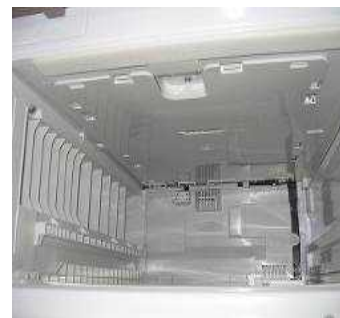
瞬冷凍室天井仕切り
