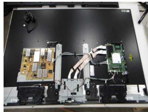
液晶式テレビ(2017年モデル) ネジ本数 : 80本 基板数 : 3枚
