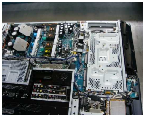
液晶式テレビ(2003年モデル) ネジ本数 : 392本 基板数 : 20枚
