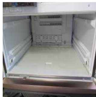
冷凍室奥側冷気吹き出し口
