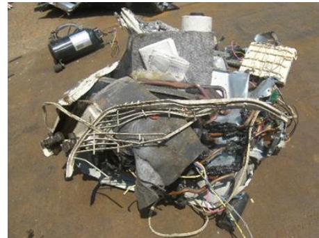
破砕されたエアコン室外機
