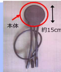
空港用 ゴムトランス （PCN（ポリ塩化 ナフタレン））
