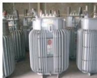
高圧トランス
