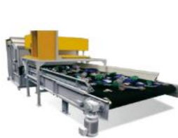
廃プラの選別設備
