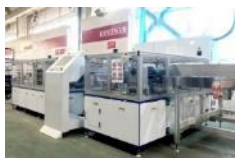
太陽光パネルリサイクル設備
