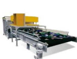
廃プラの選別設備
