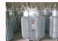
PCBが含まれる 高圧トランス
