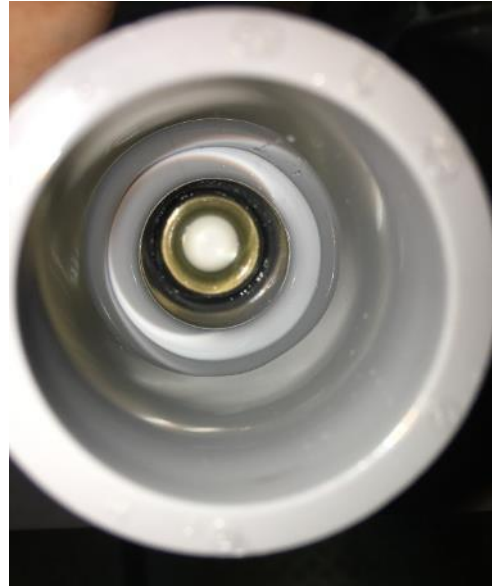
写真-4-1-2 呼び径20 No.1 (静水圧1.5MPa) 試料拡大図
