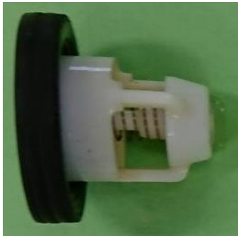
写真-4-10 呼び径20 No.7 試料拡大図と弁座パッキンの劣化状況
