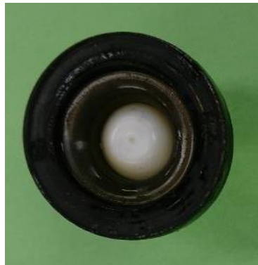
写真-4-7 呼び径20 No.3 試料拡大図と弁座パッキンの劣化状況
