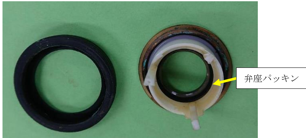
写真-3-1 逆流防止弁付きメーターパッキンの弁座パッキン（呼び径25）
