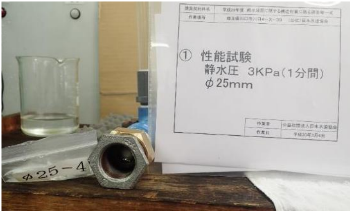
写真-4-16 呼び径25 No.4 (静水圧3kPa) 装置全体図
