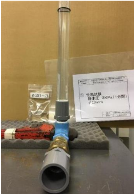
写真-4-5 呼び径20 No.3 (静水圧3kPa) 装置全体図
