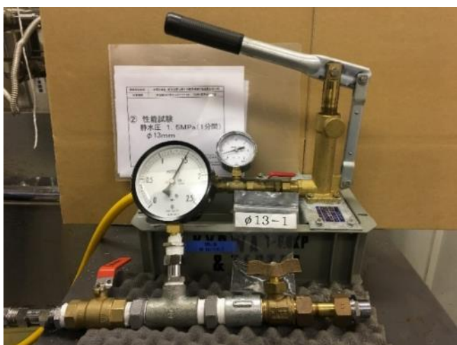
写真-4-2 呼び径13 No.1 (静水圧1.5MPa) 試験装置全体
