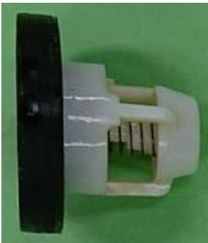
写真-4-5 呼び径20 No.3 (静水圧3kPa) 装置全体図
