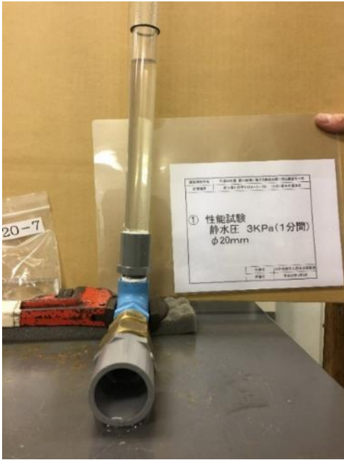
写真-4-8 呼び径20 No.7 (静水圧3kPa) 装置全体図
