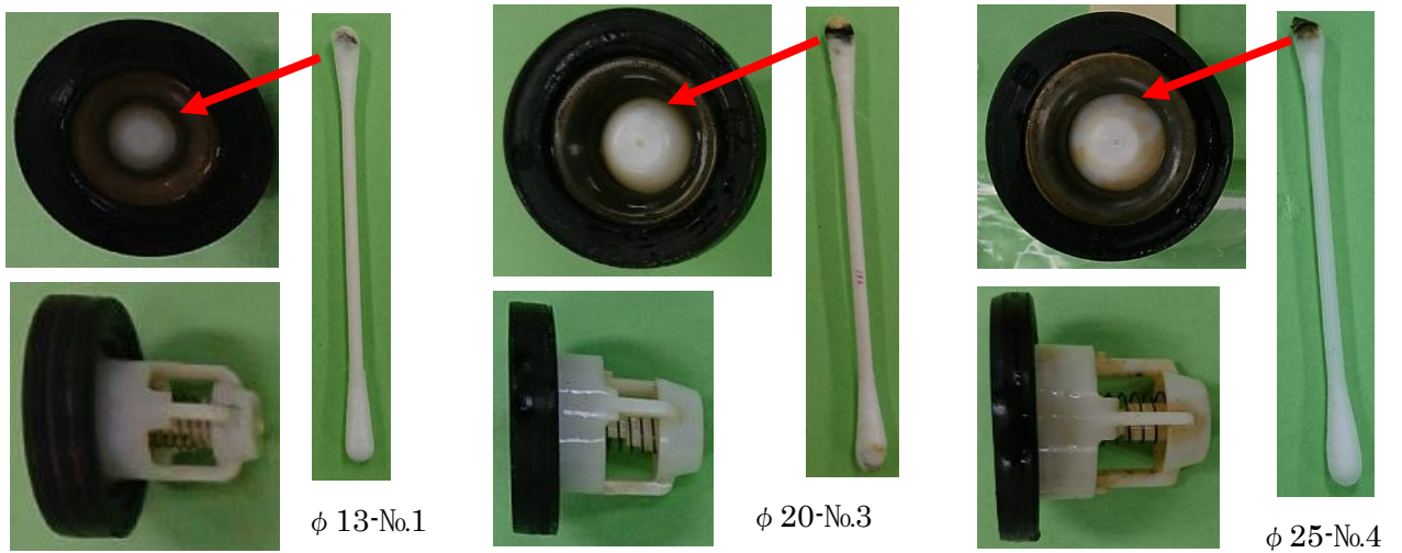
写真-3-2 不具合試料と弁座パッキンの劣化状況（赤矢印は綿棒を当てた箇所）
