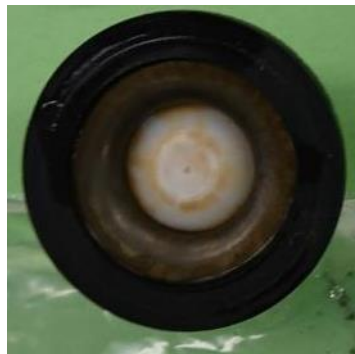
写真-4-15 呼び径25 No.2 試料拡大図と弁座パッキンの劣化状況 ※試験後、破損を確認した(逆流防止性能への影響はないと考えられる)
