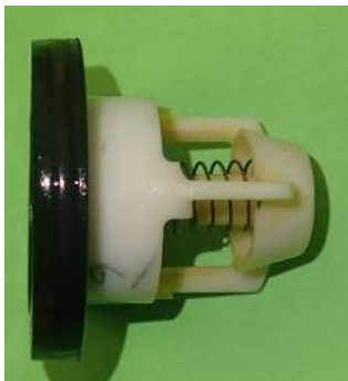
写真-4-21 呼び径25 No.6 試料拡大図と弁座パッキンの劣化状況
