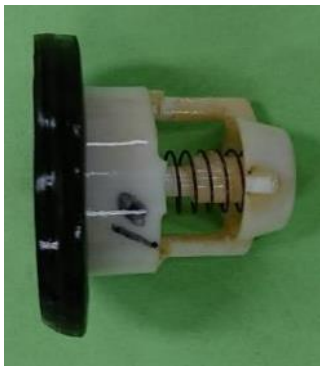
写真-4-24 呼び径25 No.8 試料拡大図と弁座パッキンの劣化状況 ※試験後、破損を確認した(逆流防止性能への影響はないと考えられる)
