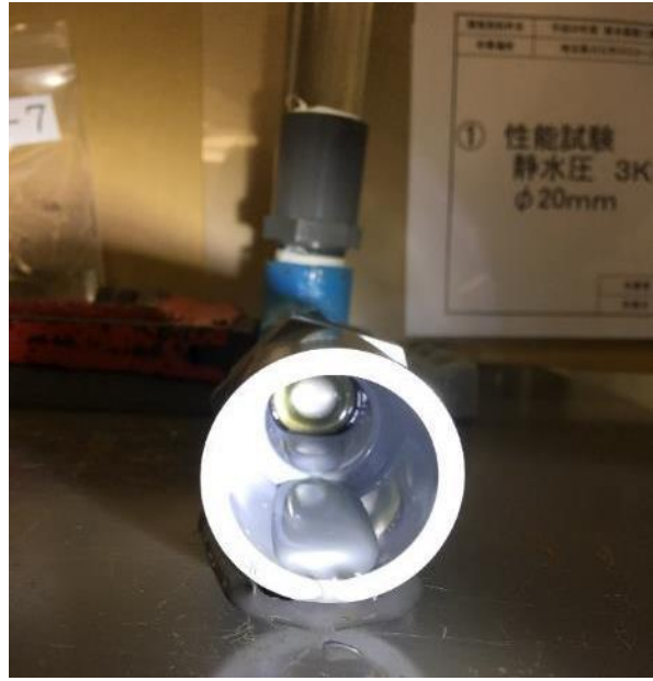
写真-4-9 呼び径20 No.7 (静水圧3kPa) 試料拡大図
