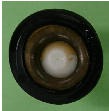
写真-4-24 呼び径25 No.8 試料拡大図と弁座パッキンの劣化状況 ※試験後、破損を確認した(逆流防止性能への影響はないと考えられる)
