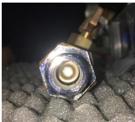
写真-4-3 呼び径13 No.1 (静水圧1.5MPa) 試料拡大
