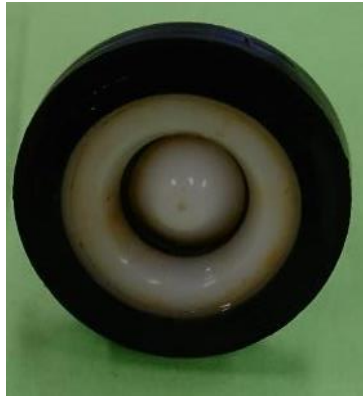
写真-4-27 呼び径25 No.10 試料拡大図と弁座パッキンの劣化状況
