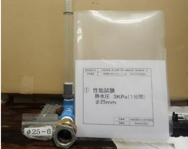
写真-4-19 呼び径25 No.6 (静水圧3kPa) 装置全体図
