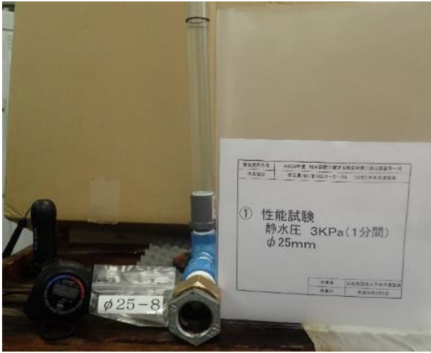
写真-4-22 呼び径25 No.8 (静水圧3kPa) 装置全体図
