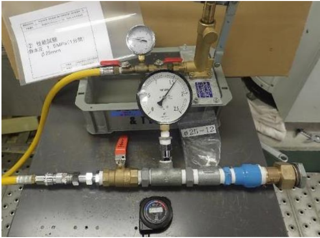
写真-4-31 呼び径25 No.12 (静水圧1.5MPa) 装置全体図
