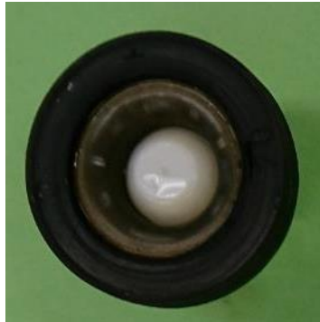
写真-4-10 呼び径20 No.7 試料拡大図と弁座パッキンの劣化状況
