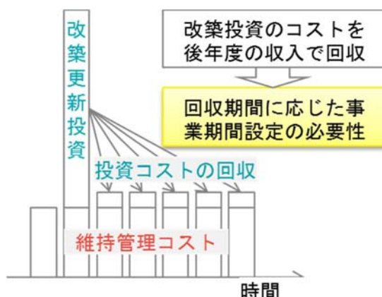
図 5.16 運営期間中の改築更新投資を後年度の収入で回収するイメージ図
