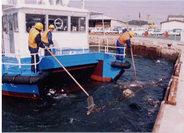
写真 2-3-1 油回収船「せいこう」による海面ごみ回収作業の様子*1
