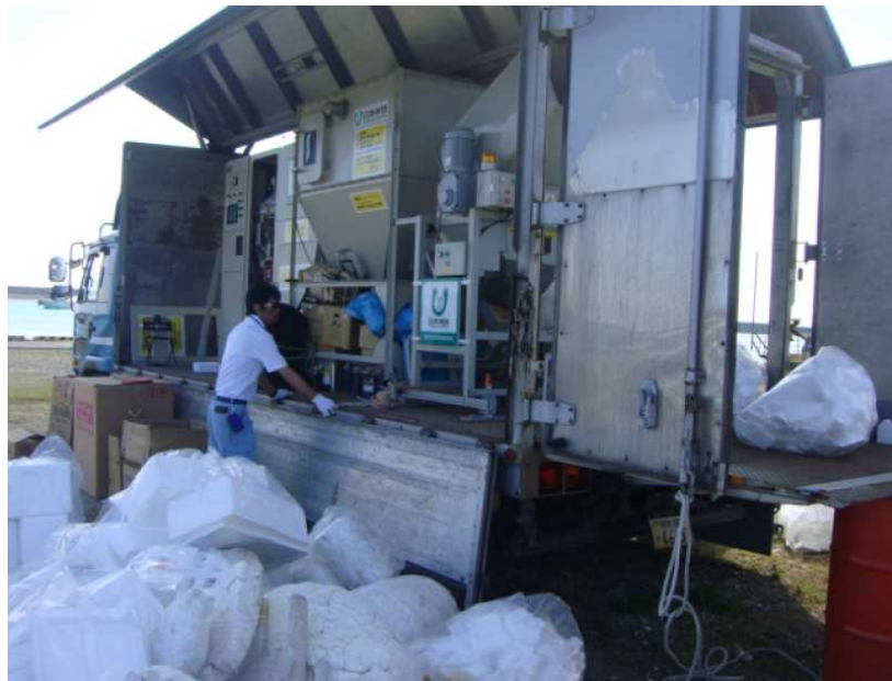
写真 3-1-1 移動式油化装置による油化作業の様子*1
