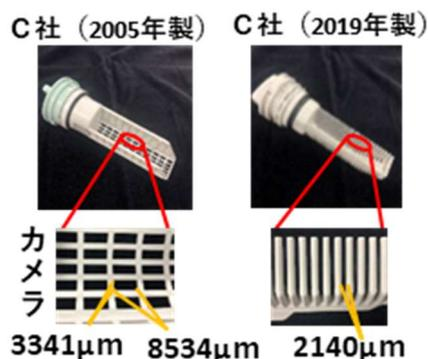
図V-2 ドラム式洗濯機附属フィルターの詳細
