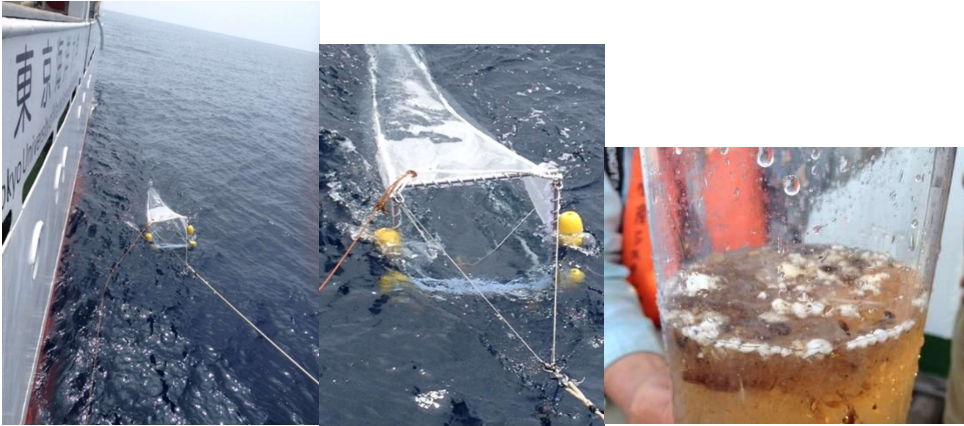
写真Ⅲ-1 ニューストンネットの曳網風景と、ポリエチレン容器に採取した試料
