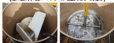
発泡スチロールの有効利用 (左:発泡スチロール、右:SD溶剤による減容化)
