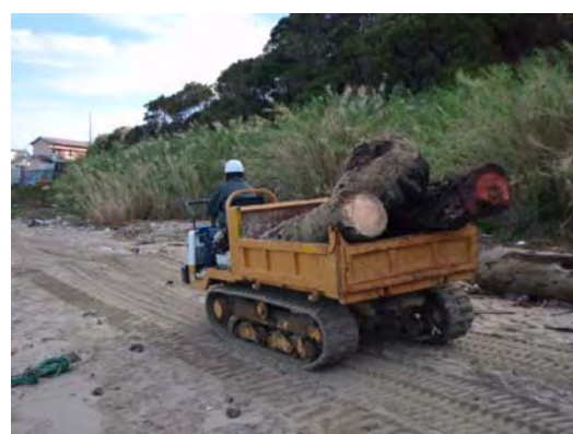
不整地車両での搬出（和歌山県串本町）
