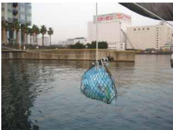
図- 2.1.5 水きりネットに入れたライターをさらに大きいネットに入れたところ(海洋大岸壁にて)
