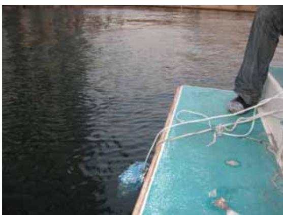
図- 2.1.6 ネットに入れたライターを浮き桟橋から海中に設置
