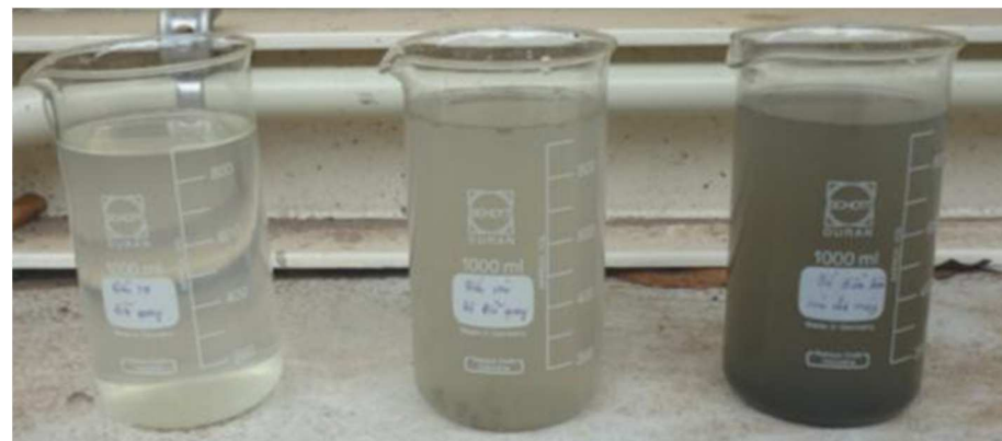
＜左から実証試験装置の処理水、流入水、そしてEqualization tankの水＞
