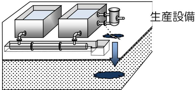
◆平成19年、金属製品製造工場で、溶液槽の配管つなぎ目が劣化し、六価クロムが漏えいし、床面の亀裂から浸透
