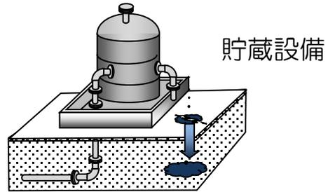
◆平成13年、輸送用機械器具製造工場で、トリクロロエチレンの貯蔵タンクへの移し替え作業による地下水汚染が判明
