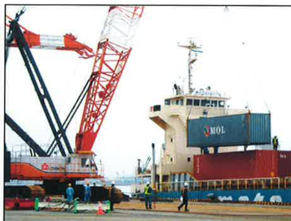
仙台港 震災後のクローラークレーン による初荷役風景(GT使用不能時)
