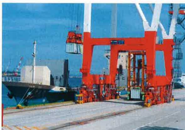
ストラドルキャリアにて岸壁移動 しガントリークレーン荷役
