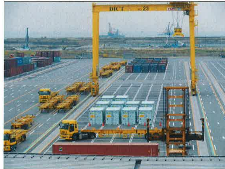
コンテナヤードに蔵置 トランスファークレーン (テナー)
