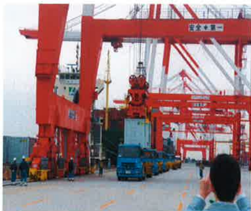
大阪港 ガントリークレーン(GT) によりシャーシ車両に積替
