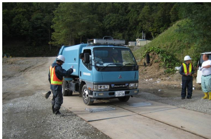
図 2.3-1 ポータブルトラックスケールによるごみ搬入車両の計測状況
