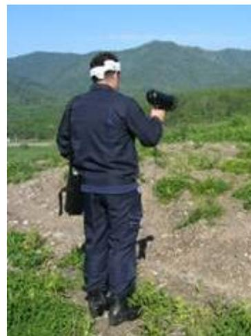
図 A 4-1 散乱光型レーザーメタン計
