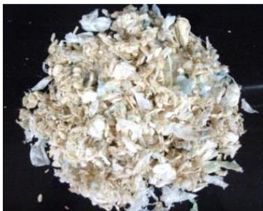
フラフ状の生成物は5000Kcal/kg以上の熱量を持ち、成分は燃料適性を有す。水分は10%未満。焼却炉の重油等に代わる助燃材としても利用可能。
