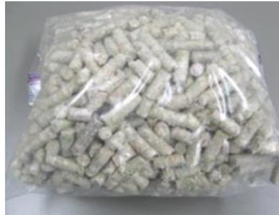
フラフ状の生成物(写真左)をペレット状の固形燃料に圧縮成形すれば、バイオスホイラーなどで活用でき、地産地消の資源循環ができる。熱量はフラフと同等。
