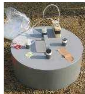
図 5-1-2 閉鎖型チャンバー (国立環境研究所撮影)
