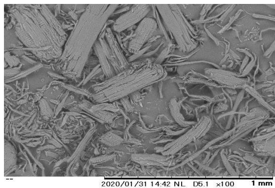
図 2-1-8 水熱処理品 CF の SEM 写真[(左)100 倍、(右)500 倍]
