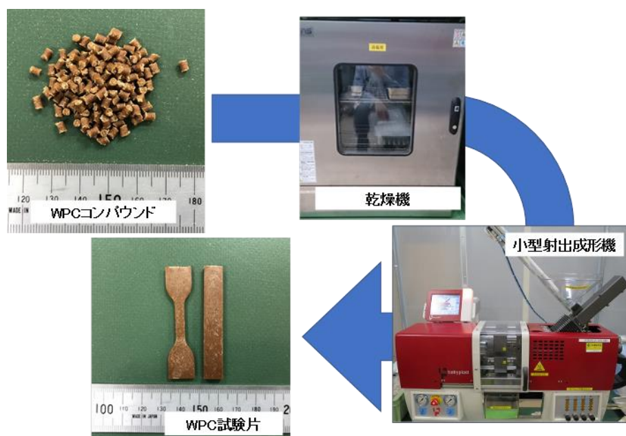
図 2-2-32 試験片作製の概要と作製された試験片の一例
