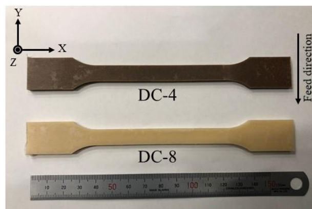
図 2-2-36 被削サンプルの一例 (DC-4、DC-8) と切削方向
