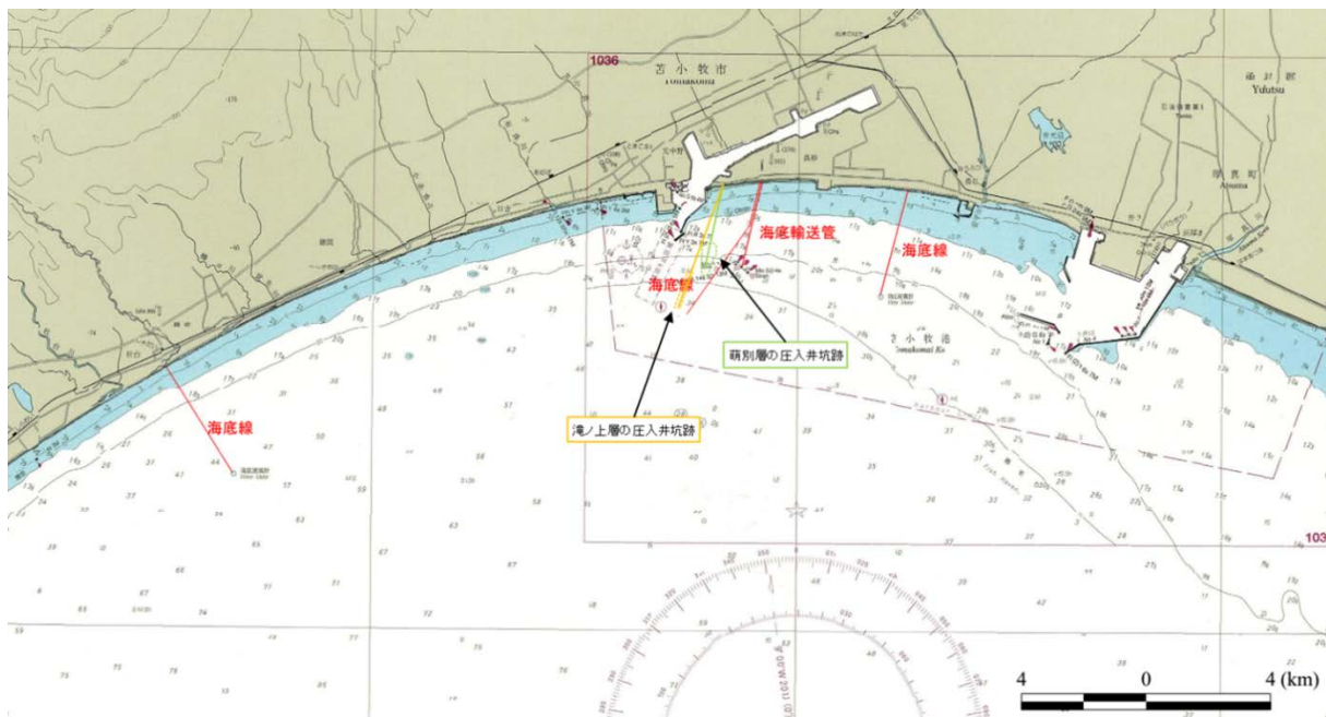
第 3.4-7 図 海底ケーブル等の敷設状況と圧入井および CO 2 プルームとの位置関係
