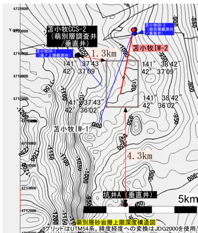
第 6.1-3 図 萌別層圧入井周辺の圧入した CO 2 の分布予測範囲と、周辺の廃坑井との位置関係
