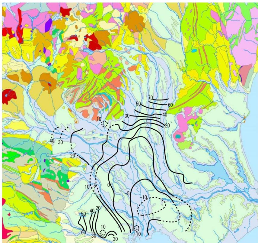
図 5-8 水文環境図の例(関東平野、水理水頭の深度別平面図 (50m~100m) )<sup>51</sup>
