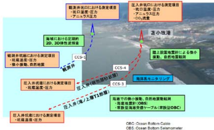
図 2.2-19 圧入中のモニタリング概念図
