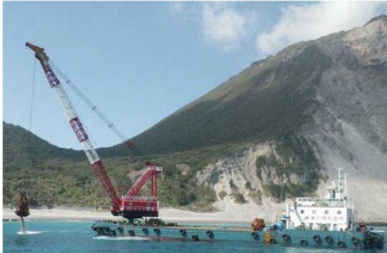
写真 2 使用する船舶（自航式起重機船）の例
