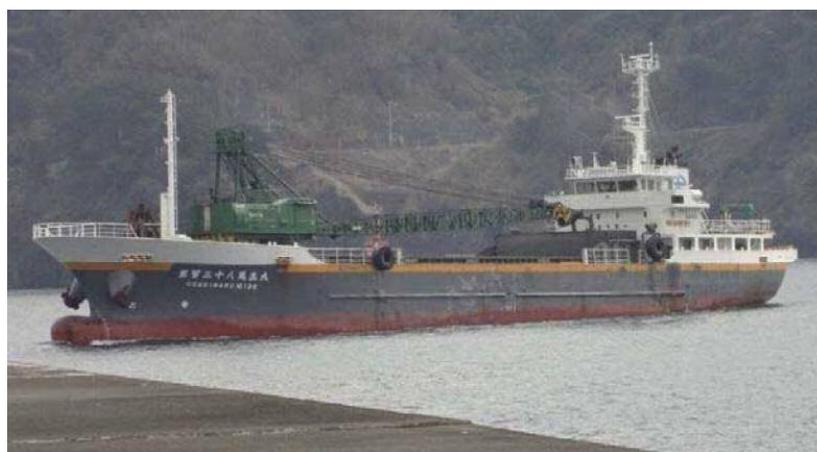
写真 1 使用する船舶（ガット船）の例
