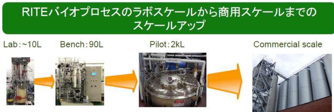
図 58 RITE バイオプロセスのスケールアップ 出所) Green Earth Institute 株式会社
