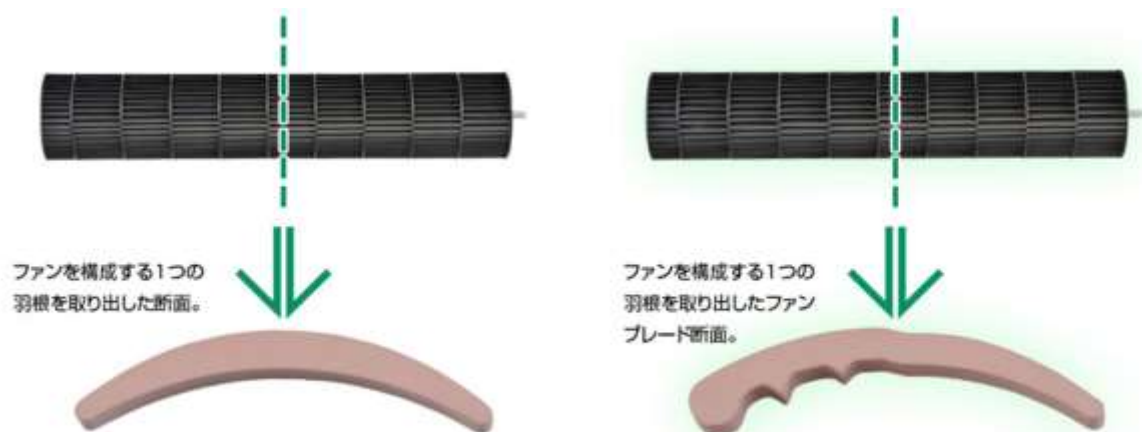
図 22 従来のファンの断面（左）と、トンボの羽根の形状を応用したファンの断面（右） 出所）シャープ株式会社
