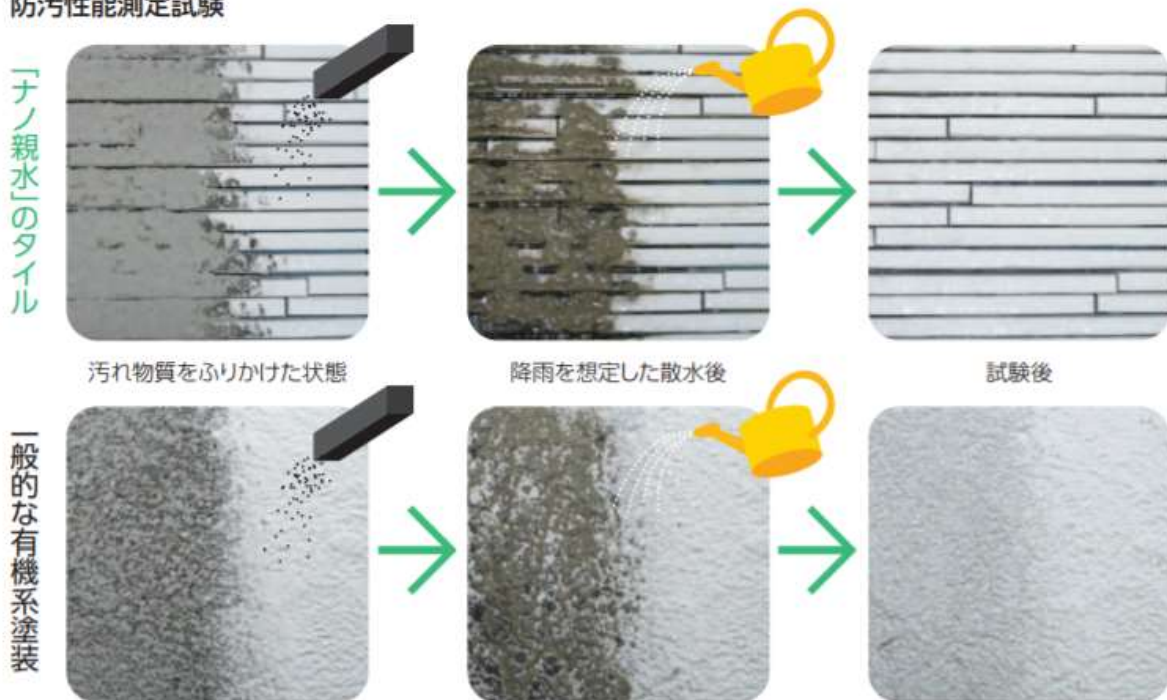
図 18 ナノ親水タイル及び一般的な有機系塗装の防汚性能測定試験 出所) LIXIL
