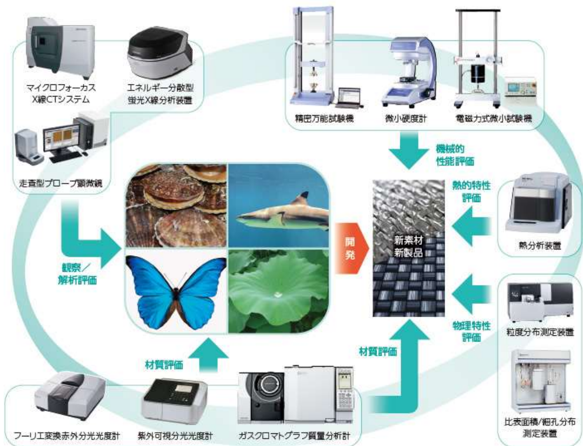
図 69 生物模倣技術を用いた研究開発と実用化に関わる分析計測機器の例 出所)「島津環境レポート 2016」(株島津製作所)
