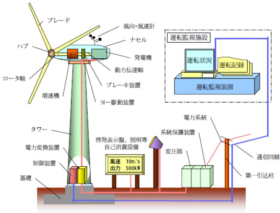
図 1 風力発電施設の機器構成例<sup>(3)</sup>
