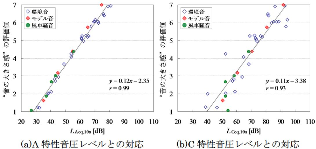
図 6 「音の大きさ」の判断結果と A 特性音圧レベル、C 特性音圧レベル<sup>(6)</sup>
