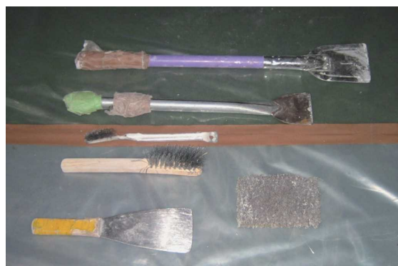
図 3.55 除去作業用の手工具の例
