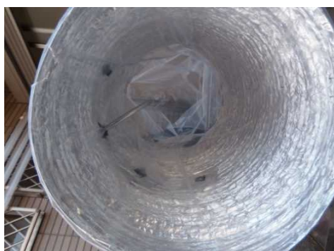
図 3.125 等速吸引ノズルを使用した場合の排気ダクト内の測定例
