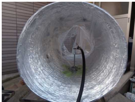
図 3.124 チューブ配管を使用した場合の排気ダクトの測定例
