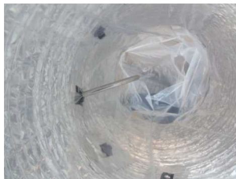
図 3.125 等速吸引ノズルを使用した場合の排気ダクト内の測定例
