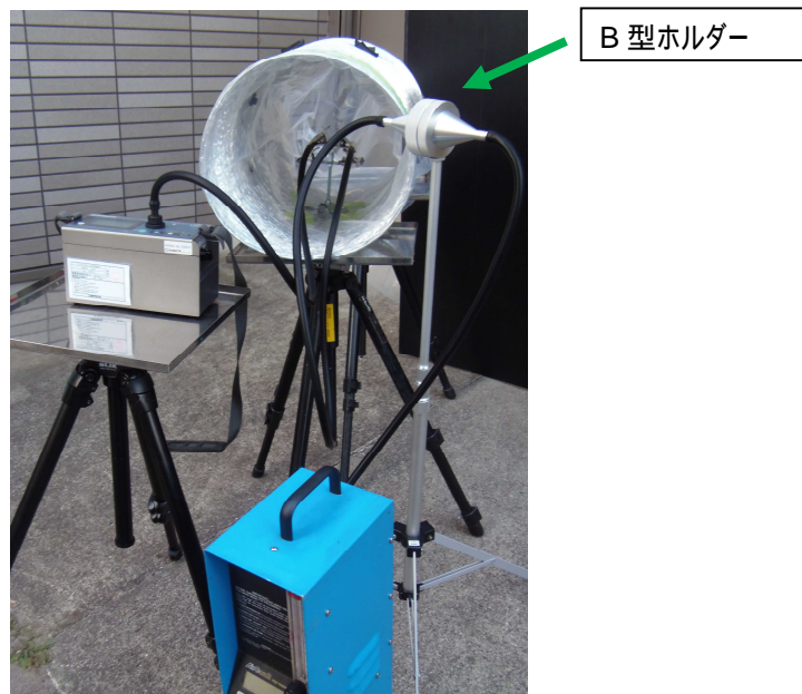
図 3. 127 排気ダクト内からのPCM法サンプル採取例
