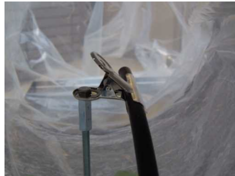
図 3.124 チューブ配管を使用した場合の排気ダクトの測定例
