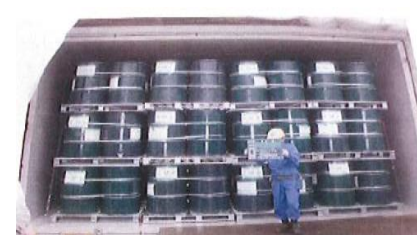
(焼却灰をドラム缶に詰めコンクリートカルバート内で保管)
