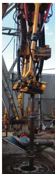
トップドライブシステム (TESCO製, 型式500HS750)
