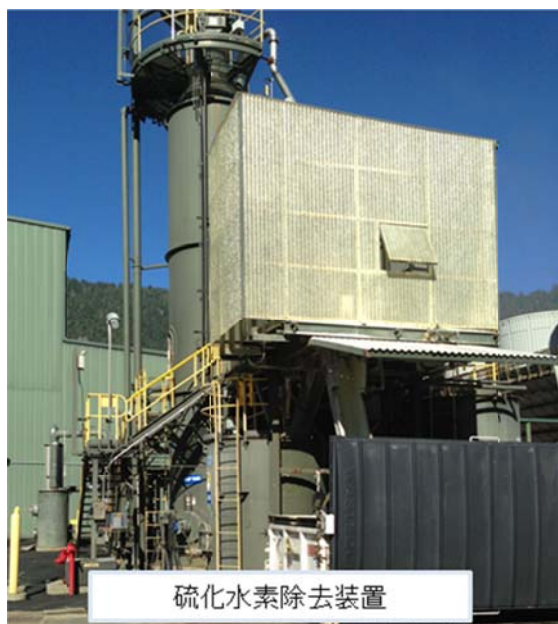
硫化水素除去装置と固形化された硫化水素
