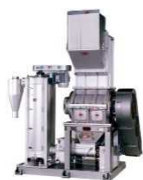
廃プラの破碎・ 洗浄・脱水設備
