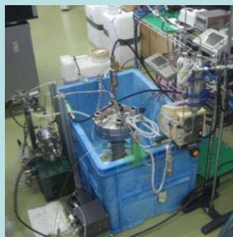
CO2ハイドレートバリア層の基礎特性を評価するための試験装置
