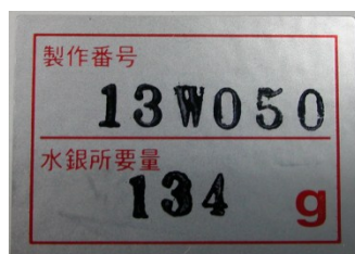
<マクラウド真空計の製品本体に貼り付けたシールの例>
