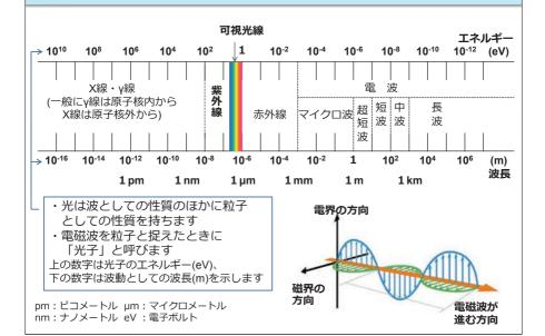
電磁波とは、電界(電場)と磁界(磁場)が相互に作用しながら空間を伝播する波のことです。波長が短くなる(周波数が高くなる)ほど、電磁波のエネルギーは高くなります。また放射線のエネルギーは電子ボルト(eV)で表されます。1 eV は 1.6 x 10<sup>-19</sup> ジュール(J)です。
